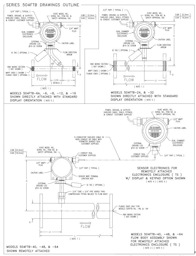
In-Line Thermal Mass Flow Meter
